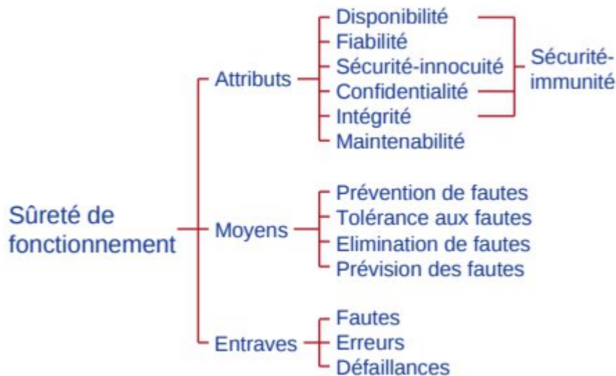
Figure 6. Arbre de la sureté de fonctionnement [Laprie]
